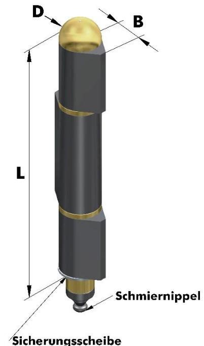
Anschweißbandrollen „AB“    3-Teilig mit 2 Kugellagern
